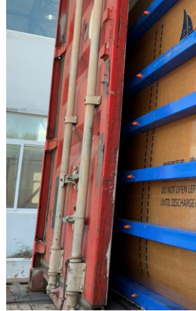
Pic.5 Bulkhead steel bars no door contact
