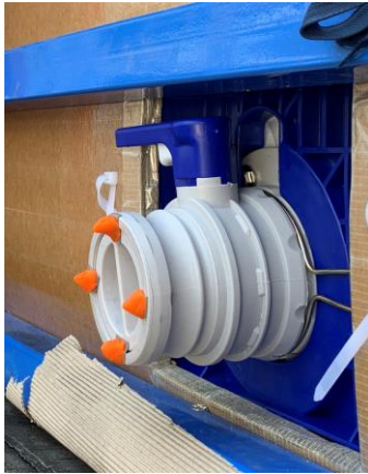
Pic.4 Bottom valve no door contact
